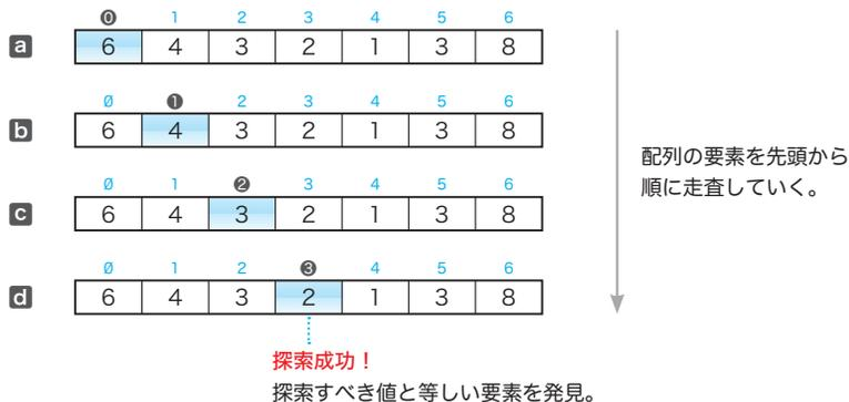
**Fig.3-2** 線形探索の一例 (2を探索:探索成功)
